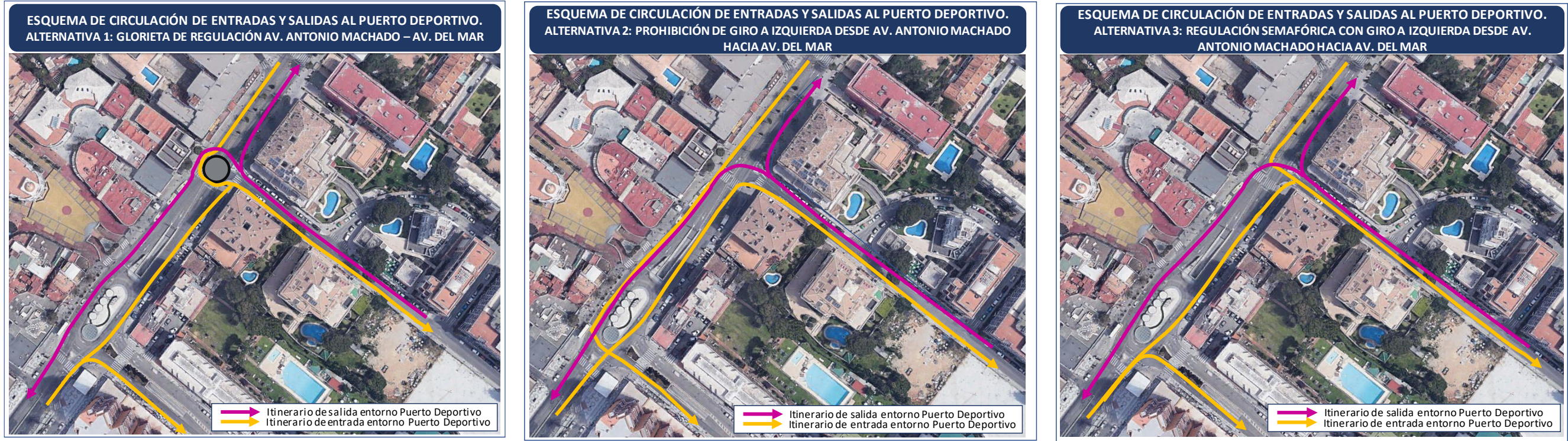
Ilustración 131: Esquemas de Circulación de las 3 Alternativas para la Intersección Avda. Antonio Machado - Avda. Mar.
