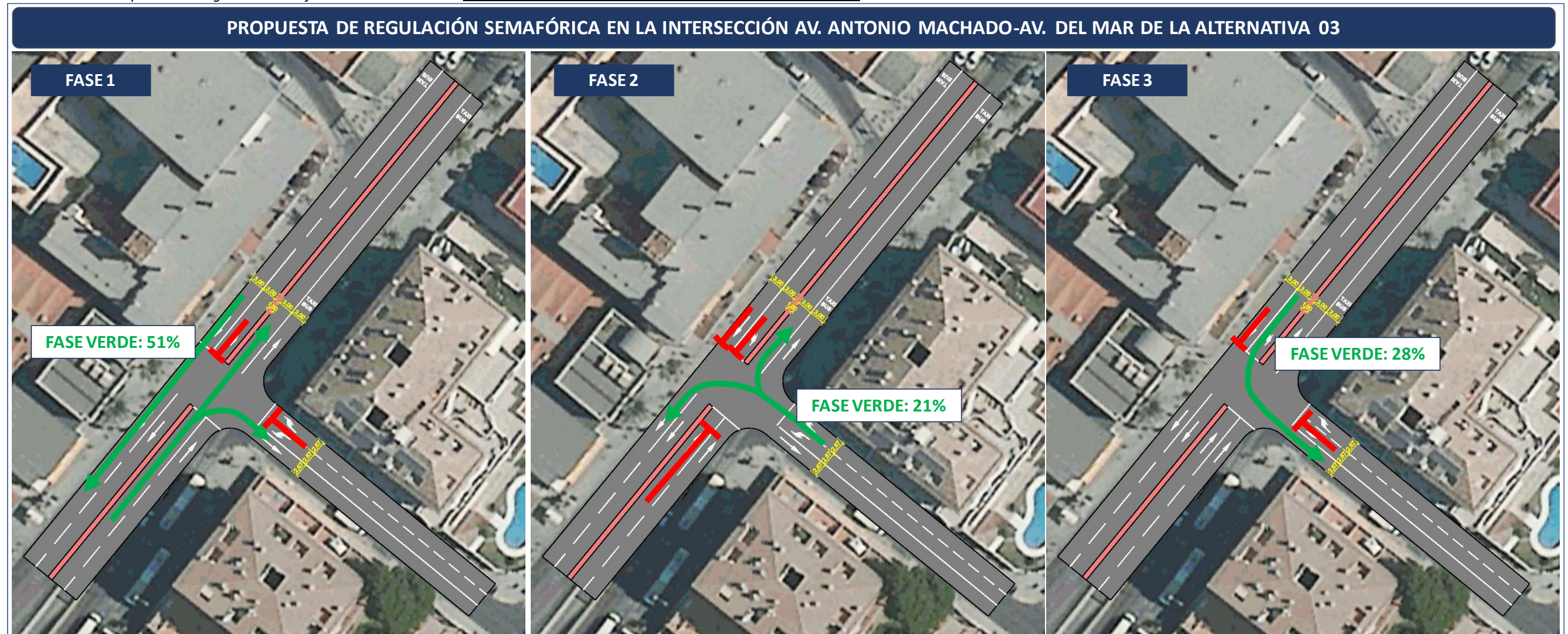
Ilustración 114: Propuesta de Regulación Semafórica en la Alternativa 3 en la intersección de la Av. Antonio Machado con Av. del Mar.
