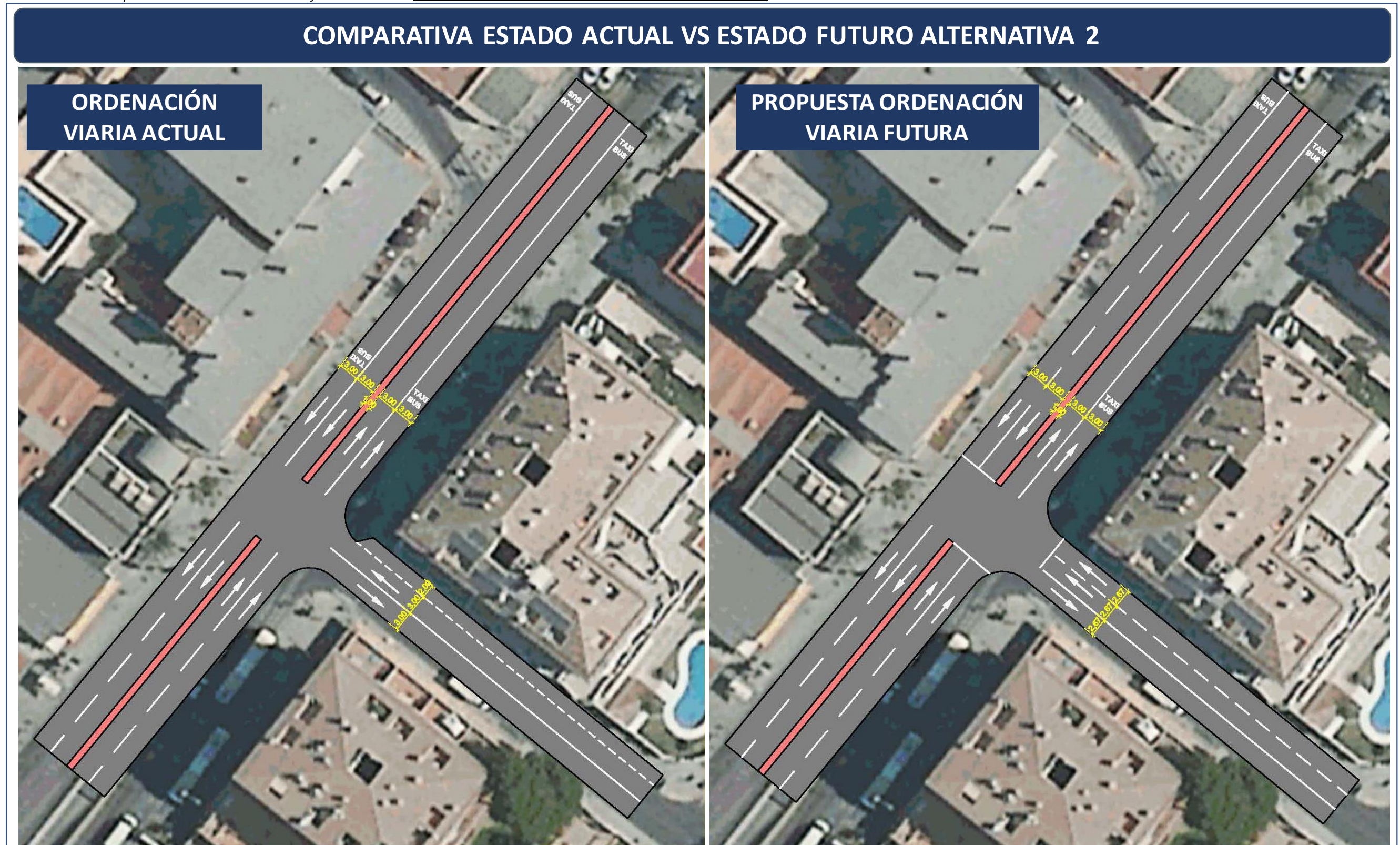
Ilustración 104: Comparativa estado actual vs estado final Alternativa 2 en la intersección de la Av. Antonio Machado con Av. del Mar.
