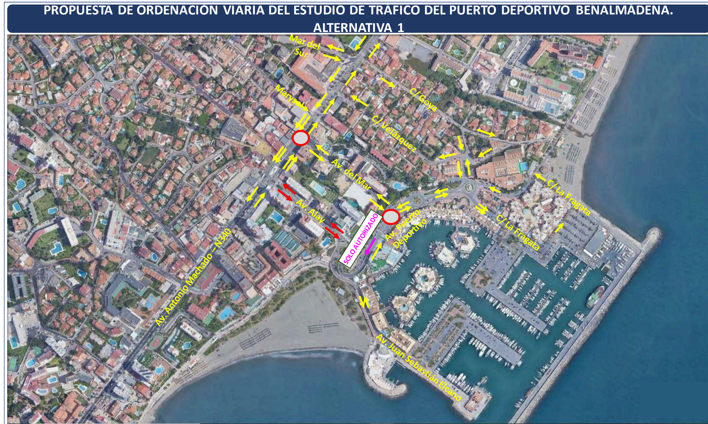
Ilustración 97: Sección Viaria final de la Alternativa 1: glorieta de regulación entre la Avda. del Mar y la Avda. Antonio Machado.
