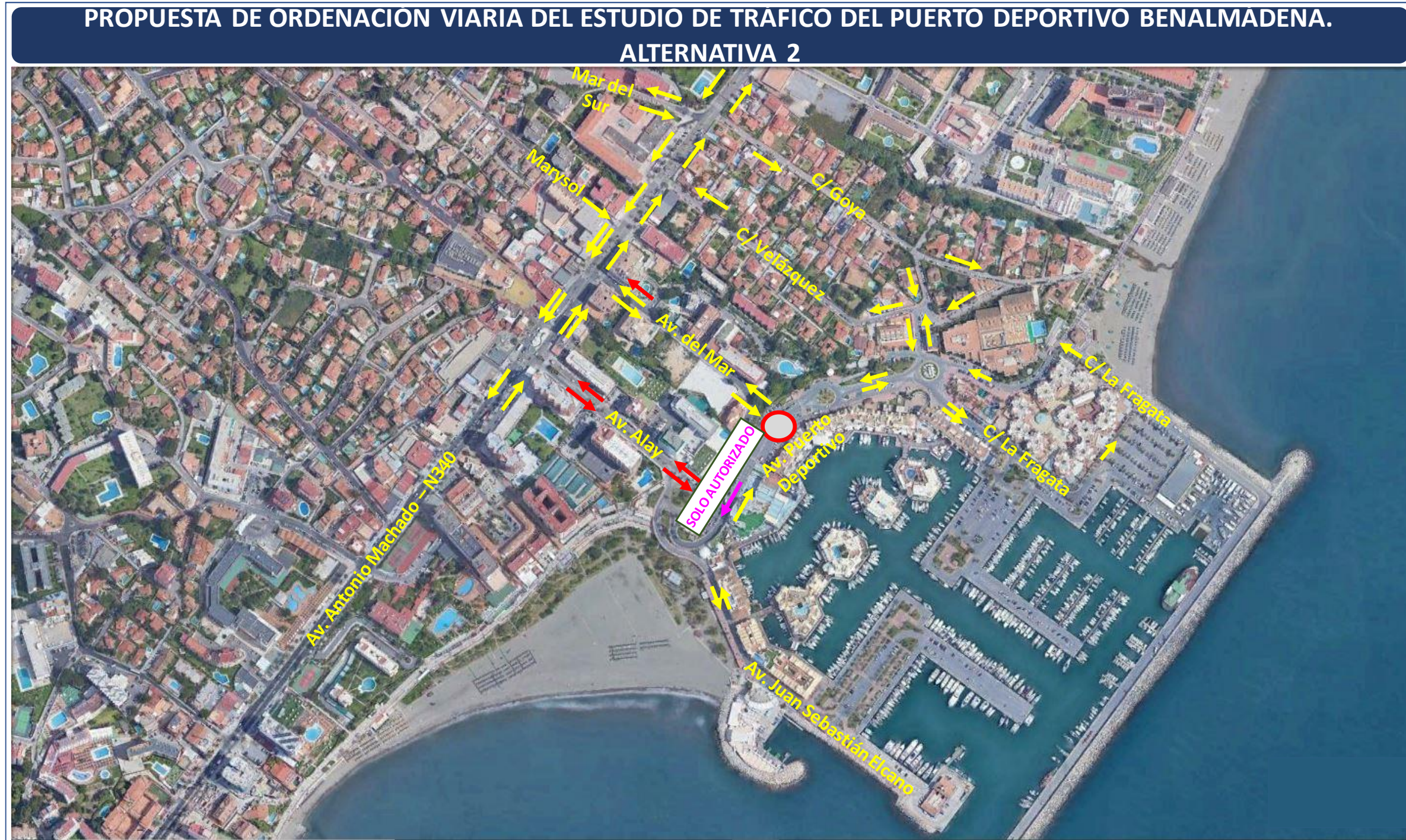
Ilustración 106: Sección Viaria final de la Alternativa 2 con prohibición de giro a izquierda desde Avda. Antonio Machado hacia Avda. del Mar.
