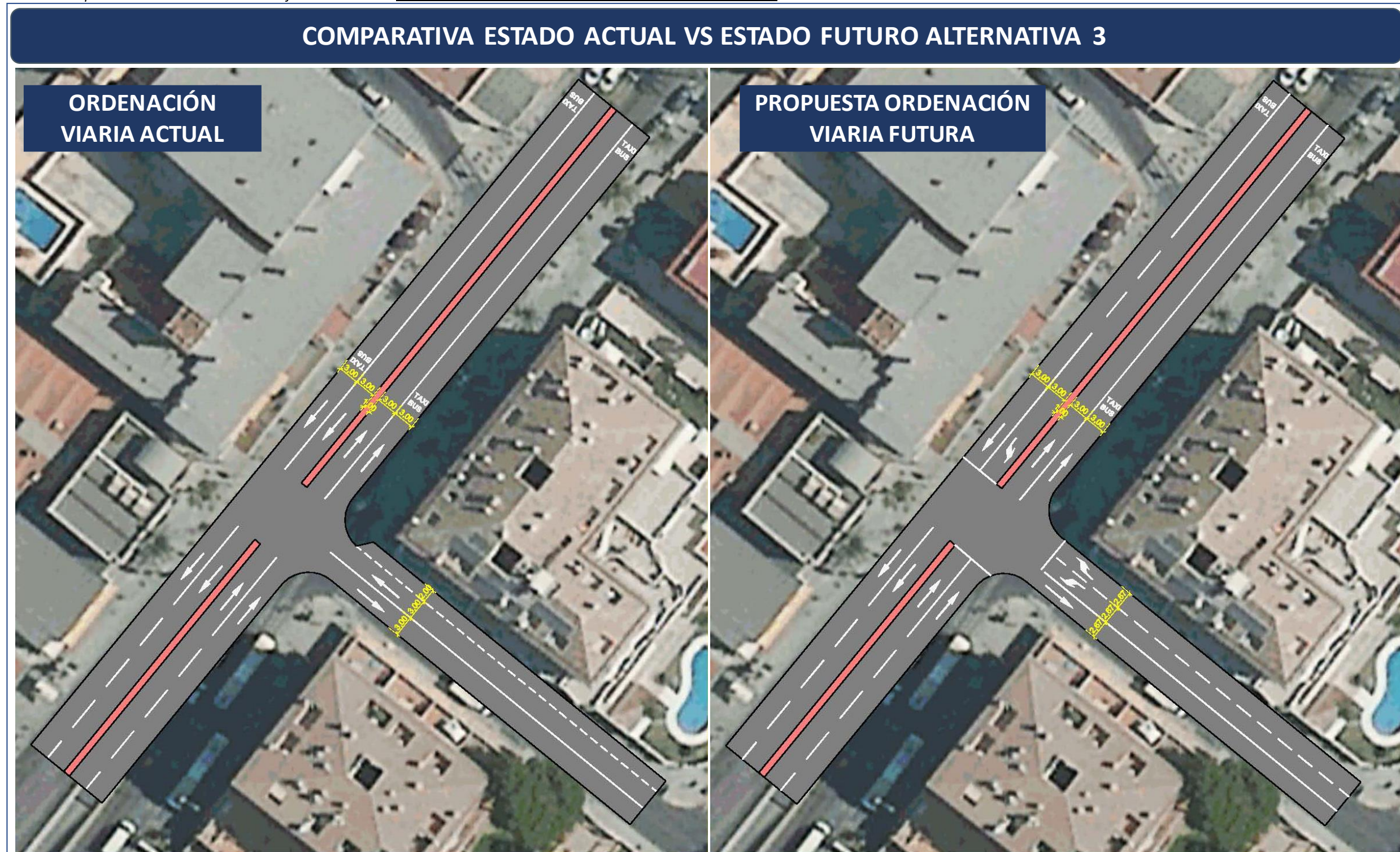
Ilustración 113: Comparativa estado actual vs estado final Alternativa 3 en la intersección de la Av. Antonio Machado con Av. del Mar.
