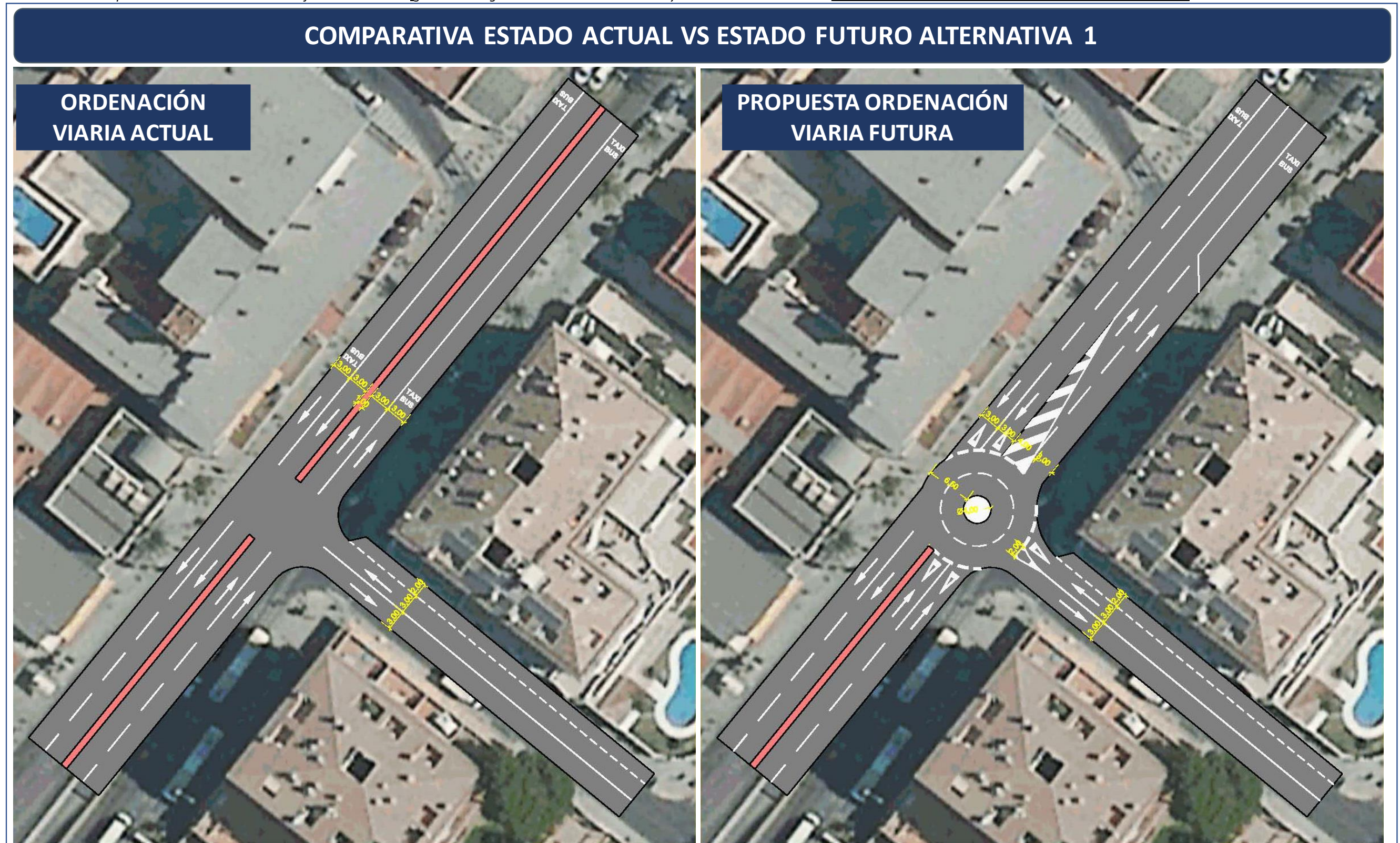
Ilustración 96: Comparativa estado actual vs estado final Alternativa 1: glorieta de regulación entre la Avda. del Mar y la Avda. Antonio Machado, en la intersección de la Av. Antonio Machado con Av. del Mar.
